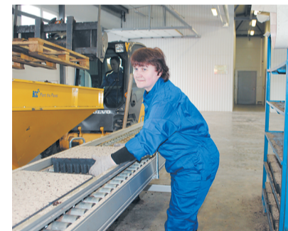
Подготовленная кассета перемещается на стеллаж
