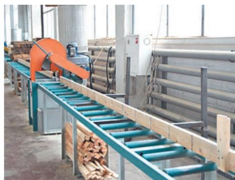
На предприятии продолжается модернизация оборудования. В цех дореверной обработки поступил современный торцовочный станок, который будет установлен взамен одного из старых, морально устаревшего. Всего в работе задействовано 10 торцовочных станков.
