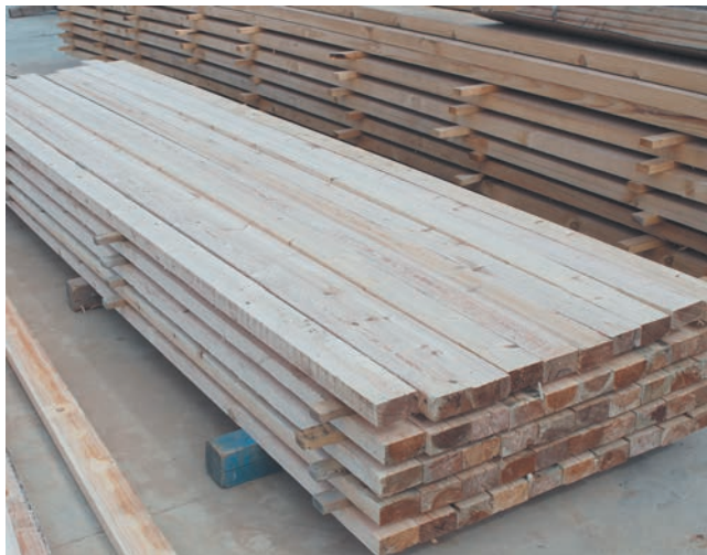
В процессе производства доска формируется в пакеты и выходит на стол – здесь пакеты со свежей доской забирает погрузчик и перевозит в сушильные тоннели.
