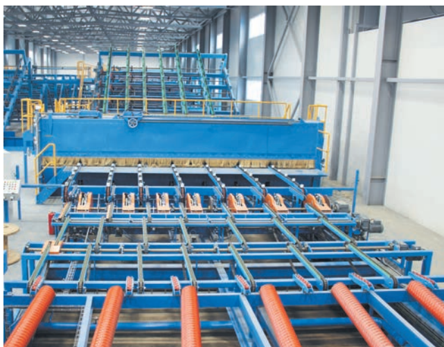
Впереди сортировка – доска распределяется по размерам и попадает в разные карманы.
