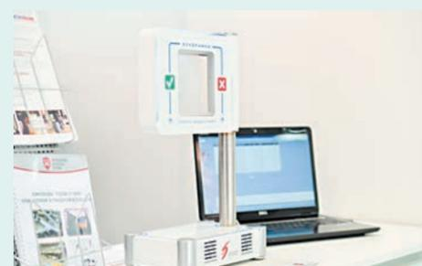
Частью системы контроля доступа на предприятии скоро станет так называемая алкорамка – оборудование для проверки трезвости сотрудников. Проверка на алкоголь проводится, в первую очередь, для обеспечения безопасности персонала, сокращения случаев травматизма на производстве и обеспечения соответствующих норм труда. Пройти через КПП, минуя проверку на алкотестере, нельзя.)
